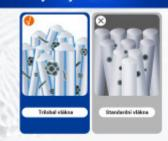
Tvar přičného řezu trojstravného zaobleného profilovaného syntetického vlákna zajistí, že se zachytí více nečistot oproti běžnému kulatému vláknu zdůvodu větší filtrační plochy
